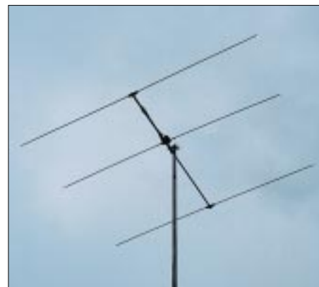
Bild 2: 3-Element-Yagi für 6 m – als Monobander immer noch die zweckmäßigste Wahl
