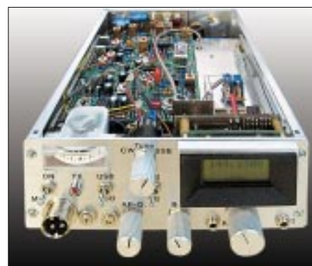
Die Hohentwiel -Modifikation von DF5SL kommt mit Fertigschaltungen aus, erreicht F = 1,1 dB und verfügt über eine Digitalskala.
