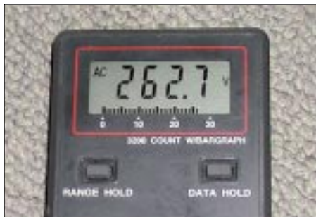
Netzspannung von knapp 263 V! Zum Glück nahmen beide Linears keinen Schaden.
