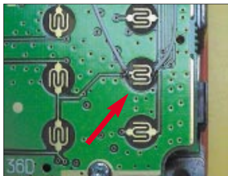
Bild 2: Lötverbindungen an der Call-Taste im Detail
