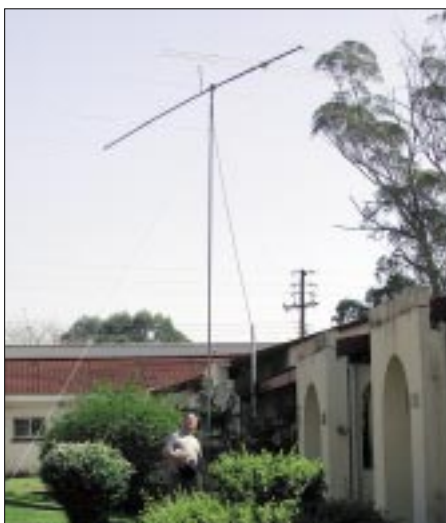
Die 6-El.-Yagi für 50 MHz in KG53NP
