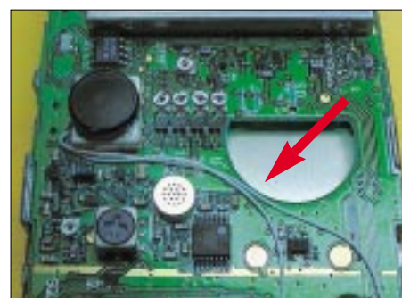
Bild 3: Kabelführung entlang des halbmondförmigen Lautsprecherausschnitts
