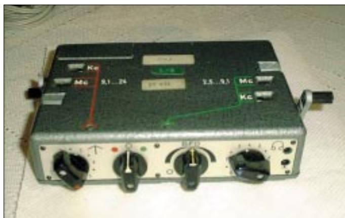
Der volltransistorisierte Empfänger SP-15
